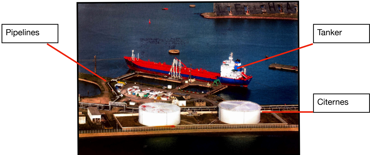
Navire pétrolier déchargeant sa cargaison, dans le port du Havre, en France.
