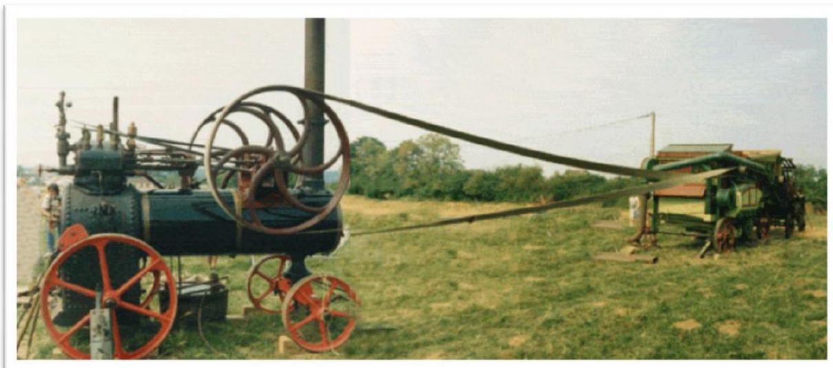
→ *Une batteuse à vapeur* : la courroie actionnée par la machine à vapeur permettait à la batteuse de fonctionner : de séparer le grain du reste l'épi.
